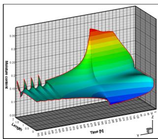
Teneur en eau moyenne suivant l'épaisseur de l'échantillon en fonction du temps
