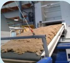
Formation de la nappe de fibres par la machine Airlaid
