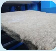
Consolidation thermique dans un four à 170°C .
