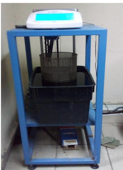
*Fig. 2. Appareil de la pesée hydrostatique.*
