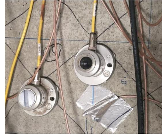
**Pyranomètre & Pyrgéomètre**
