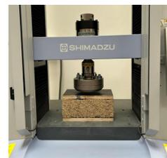
Mesure de la résistance à la compression des BBC
