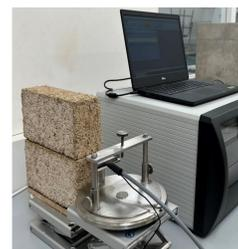
Mesure de la conductivité thermique des BBC par le dispositif Hot Disque
