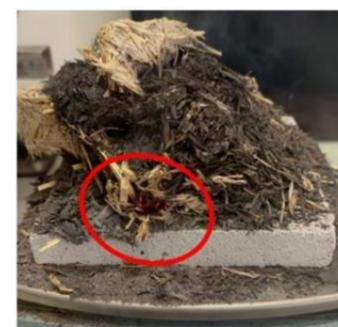
Feu couvant sur béton biosourcé (avant et après)
