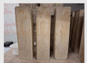
Eprouvettes de pâte de ciment fissurées par retrait de dessiccation
