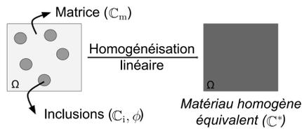
Propriétés mécaniques du milieu homogène équivalent :
