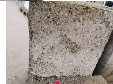
Aspect de la surface de découpe (Matériau homogène / Pas de défauts apparents)
