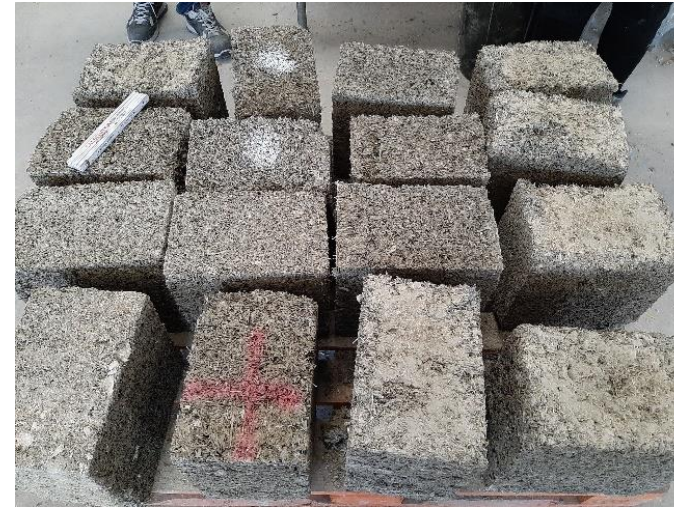
Découpe des blocs pour les essais de caractérisation
