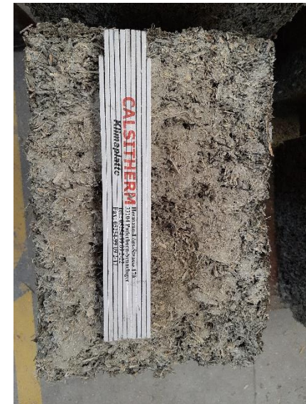
Aspect de la surface de découpe (absence totale de farinage)
