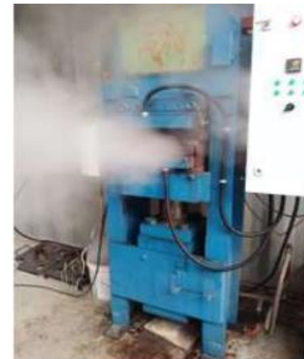
Método 1: Consolidación por inyección a vapor
