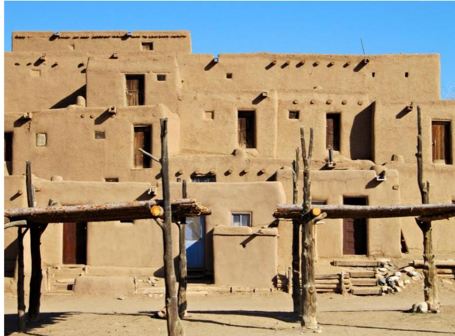
**Maçonnerie de briques de terre crue**
