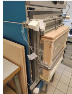
Dispositif expérimental de l'essai bi-climatique à l'échelle du mur
