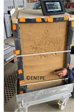
Figure 1 : Muret d'essai de remontée capillaire
