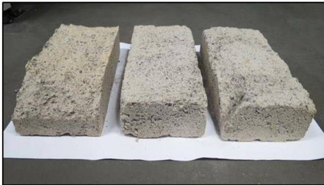
Bio-briques utilisant le carbonate de calcium bioprécipité (Lambert & Randall, 2019, p. 89)
