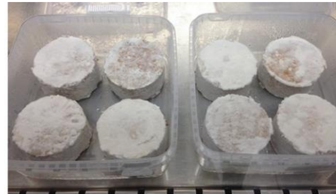
Blocs de composites biosourcés avec matrice mycélium (Elsacker et al., 2019)
