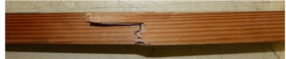
Nouveaux mécanismes de rupture après vieillissement
