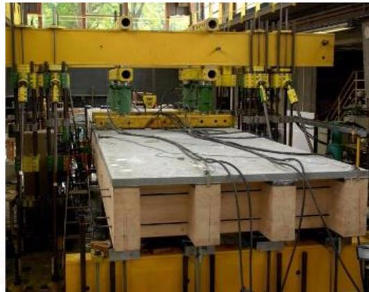
Tablier d'un pont bois/béton/composite (Ben Mekki 2007)
