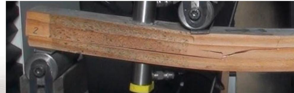
Rupture en cisaillement du joint de colle
