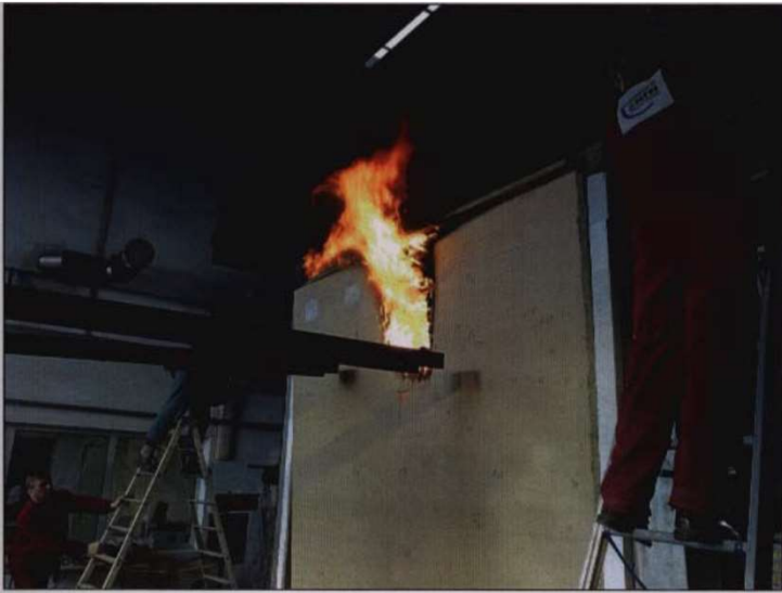
Mur bois – OSB + fibre de bois
