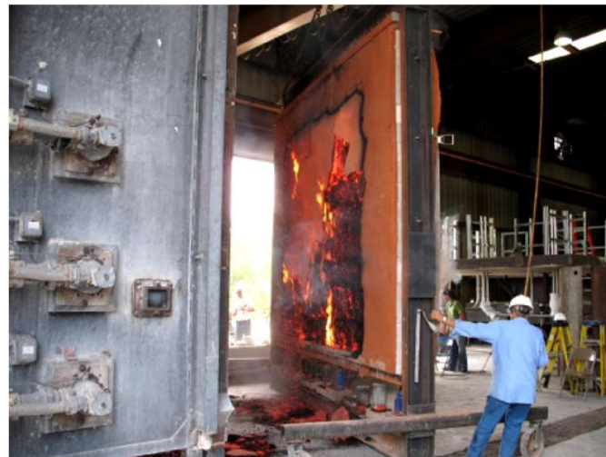
Mur paille - enduit terre
