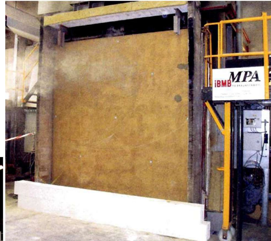
Mur paille - enduit terre
