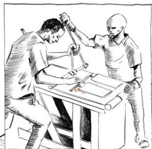
LA TERRE EST COMPRIMÉE MANUELLEMENT.
