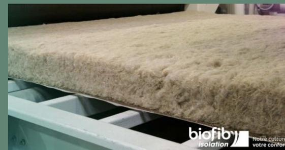
$\lambda < 0,038 \text{ W/(m.K)}$  Mva = 35 kg/m<sup>3</sup>
