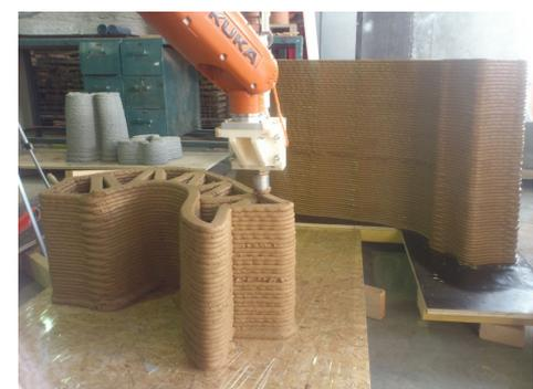
Fig. 11. Impression 3D de pièces avec zigzag
