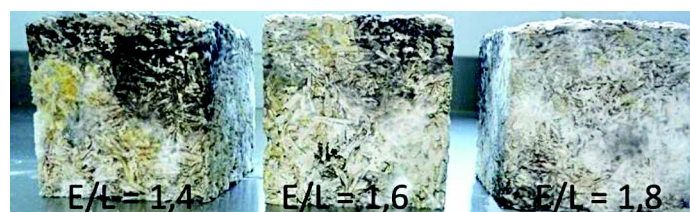
Fig. 2 : bétons de chanvre recouverts de champignons après 4 mois d'incubation
