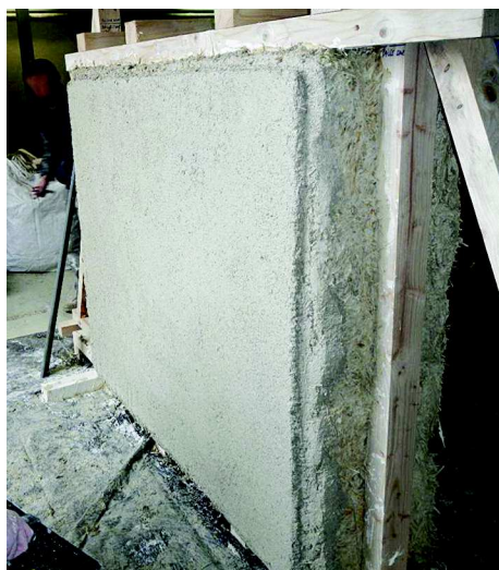
Mur expérimental en paille porteuse pour essais de laboratoire
